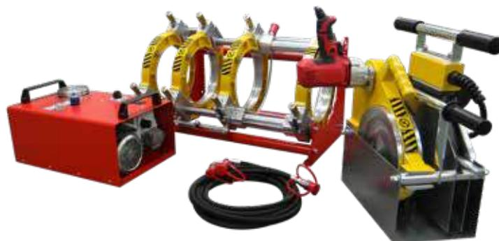
Machine à souder bout à bout pour tubes et raccords en PE, PP et autres résines thermoplastiques.
