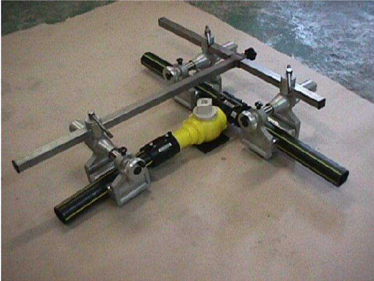
Utilisation du positionneur ARIAS PM 90/160 avec coquille de 63.
